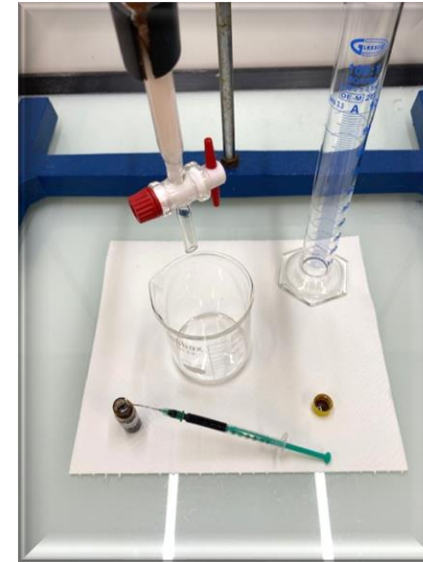
Colonne Alox (10g) avec 1 mL d'extrait chargé
